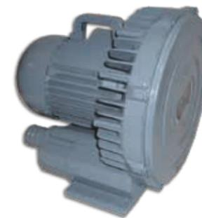
Une turbine en trois dimensions combinée à des changements de section dans le conduit circulaire permet un écoulement atténué de l'air et un bruit faible. Un moteur spécial de haute qualité, court dans le moment de torsion de démarrage, équilibré en fonctionnement et de faible consommation tout en conservant d'excellentes performances. Un système de lubrification élaboré sans huile pour produire un air mieux assaini.
